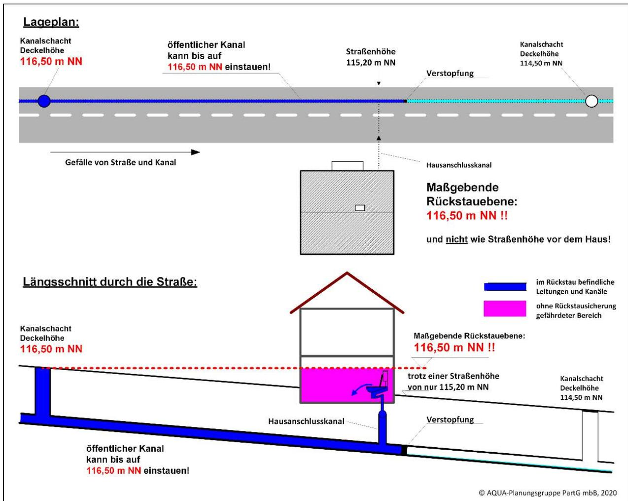
In diesem Beispiel wird die Höhe der Rückstauenebene durch die Höhe des bergauf liegenden Kanalschachtes definiert, d.h. dies ist die erste Stelle, an der das Wasser aus dem Kanalnetz auf die Geländeoberfläche austreten kann.
